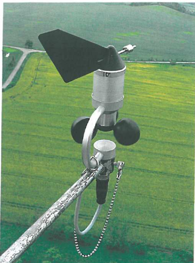
Obr. 2 – Miskový anemometr a akcelerometry umístěné na stožáru
