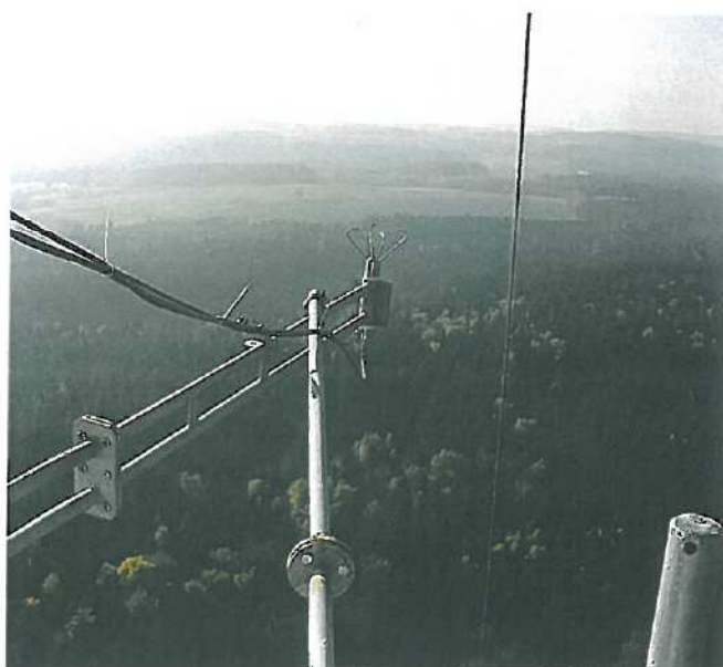
Obr. 3 – Ultrazvukový anemometr a tenzometry nalepené na napínacích tyčích kotevních lan
